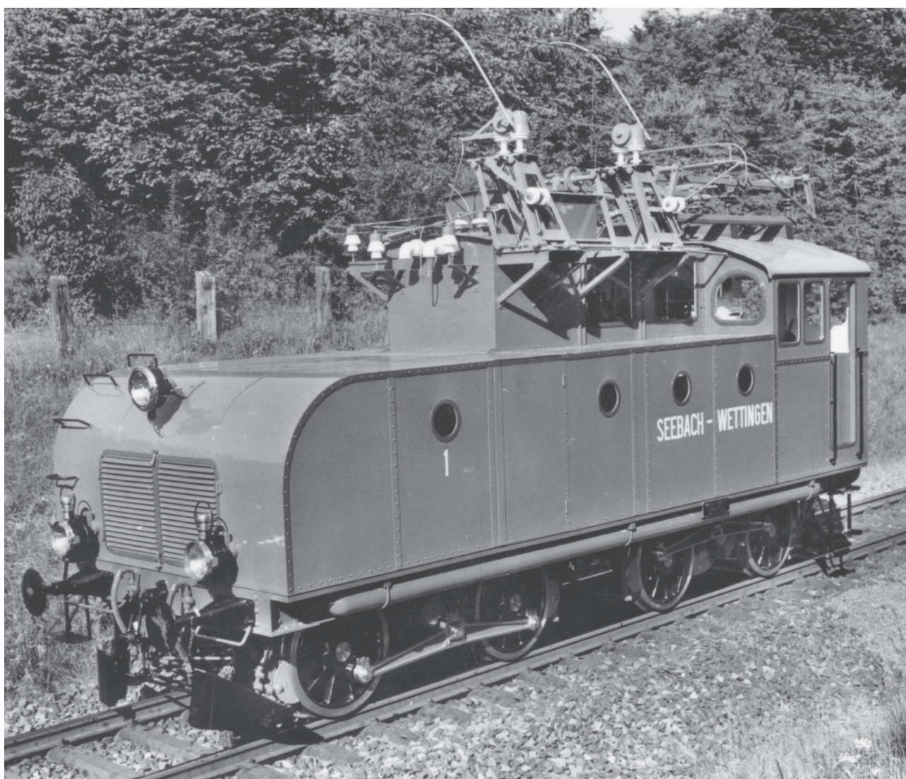
Elektrolok Ce 4/4 Nr. 1 Eva, Einphasenwechselstrom-Lokomotive der MFO. Versuchslokomotive Seebach-Wettingen. Baujahr 1904. Bild: Verkehrshaus der Schweiz, Luzern
